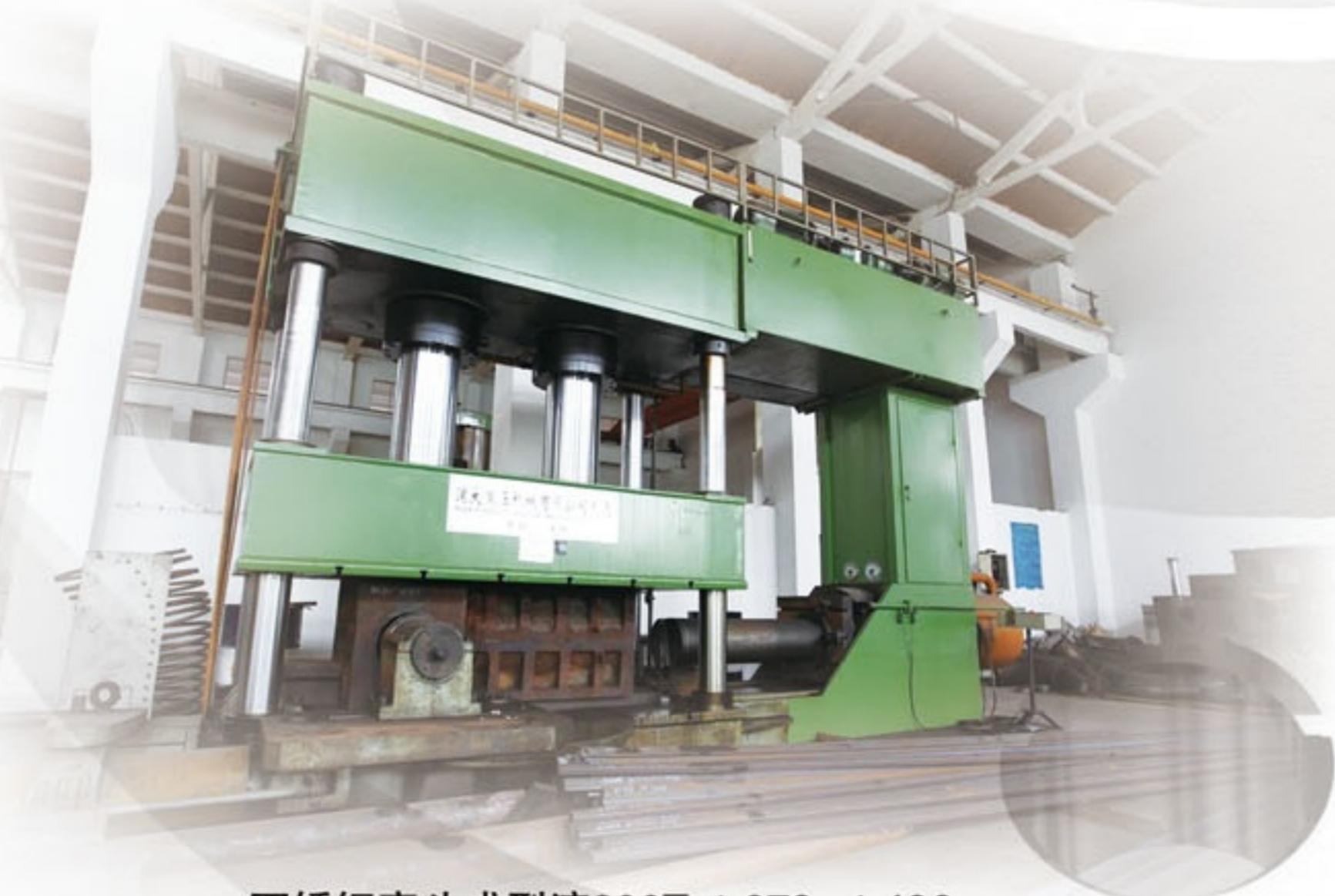
不锈钢弯头成型液800T  $\phi$  273-  $\phi$  426
