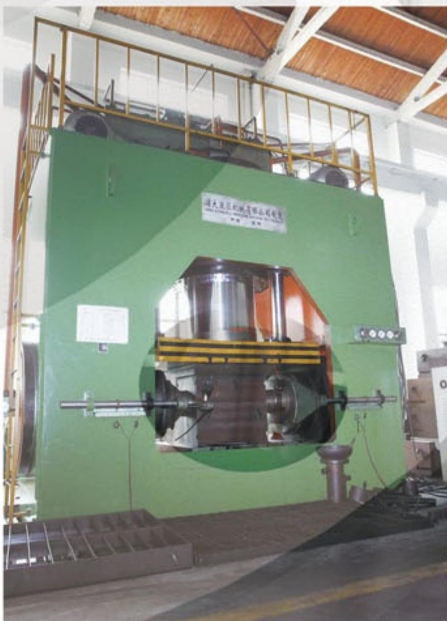
三通成型液压机1600T  $\phi$  159- $\phi$  426
