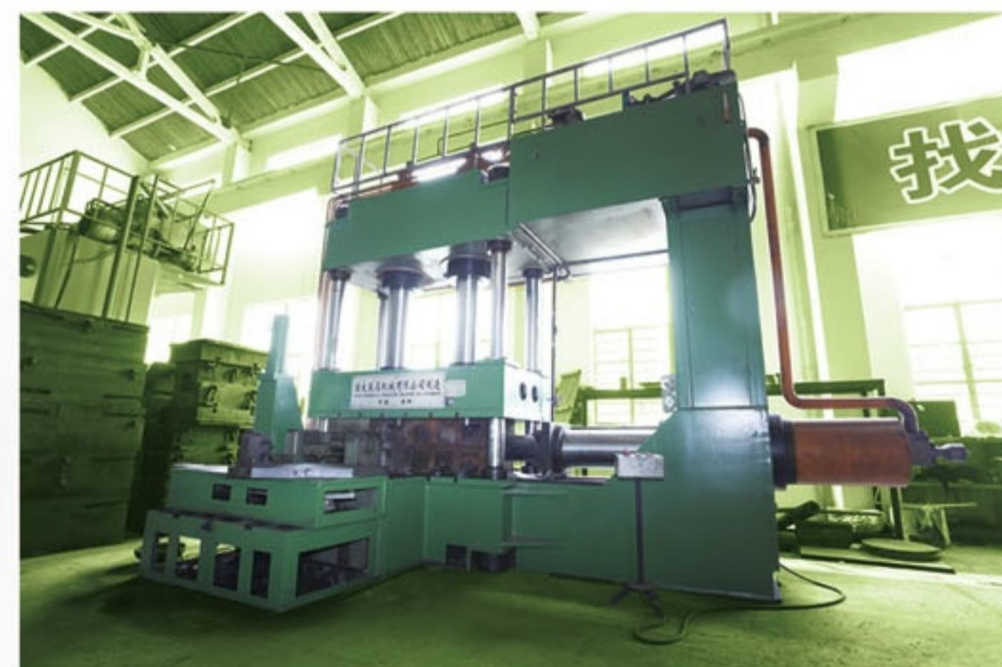
不锈钢弯头成型液压机400T  $\phi$  140- $\phi$  219
